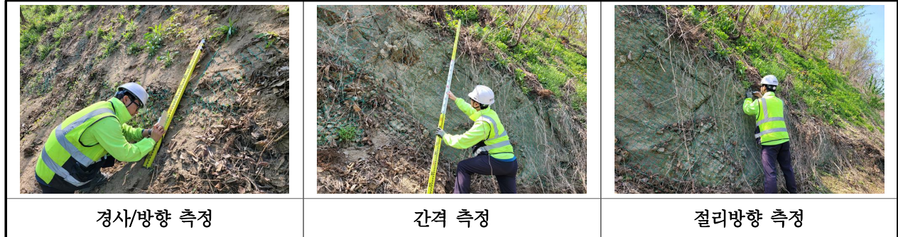
【사진 2.4.1】 불연속면 측정 현황
